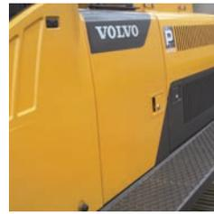
HEAVY-DUTY UNDERHOUSE GUARDS CATWALKS, PUMP & RADIATOR DOORS
