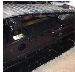
HEAVY DUTY TOP ROLLER BRACKETS & IDLER REINFORCEMENT
